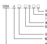
外形小分类: 0到9, (小分类0或无小分类时可省略)显示方式: 1-单行数码显示 4-三码数码显示 5-按键切换数码显示7-双行或三行数码显示 9-三/四行数码显示 Y-液晶显示(LCD)系列代号:表示多功能、网络电力仪表仪表外形: 1: 160×80槽形 2: 120×120方形 3: 80×80方形9: 96×96方形 A: 72×72方形功能代号: E-多功能电力仪表 Z-网络电力仪表
